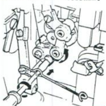
overlockgrijper aandrijfhevel voorkant
